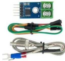
Gambar 5. MAX6675 Type K (Sumber : Kuncoro dkk., 2023)
